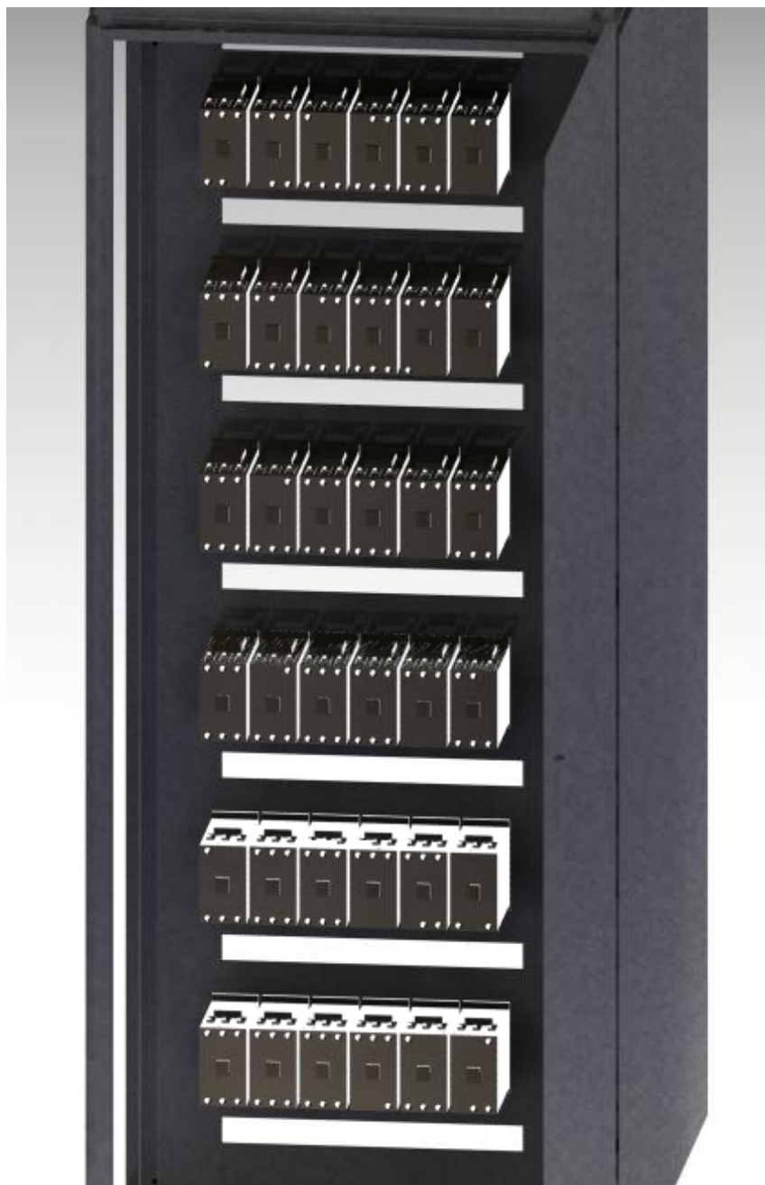
Figur 7.10 Kontakter monterade i skåpet
