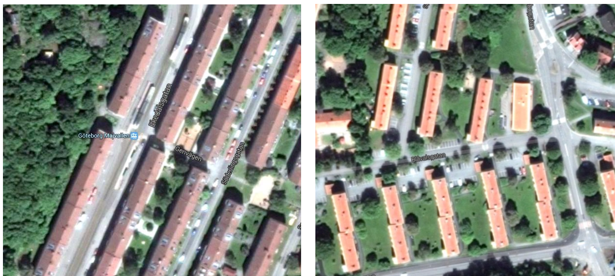
Figur 24. På bilderna visas fyra exempel på lösningar med avtagande bullerdämpningsförmåga. Bättre, bra, sämre, sämst (Höstmad, 2012).
