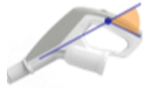
Figur 3.4 lutningsvinkel (tilt angle) som avgjorde uträkningar för dammsugshandtagen. Denna har drygt vinkeln 50 grader (teoretisk referensram sidan 9).
