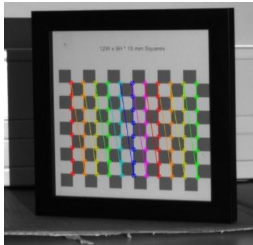
Figur 4.20. En lyckad kalibreringsbild i FlexScan 3D.
