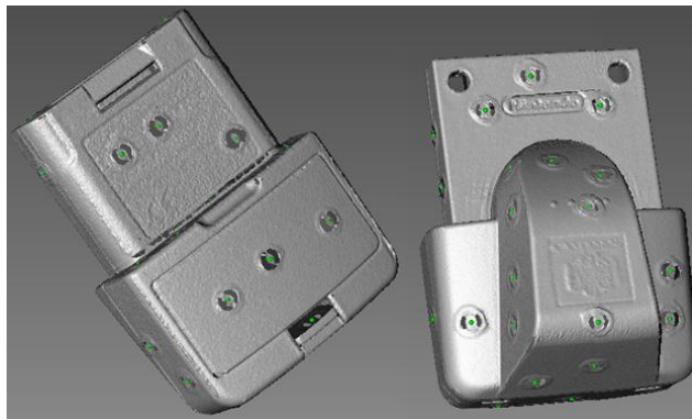
Figur 4.28. Skanning med markers. Var grön prick representerar en hittad marker.
