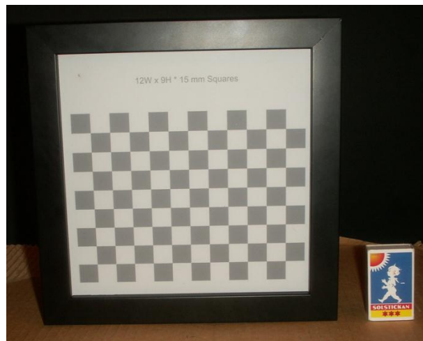
Figur 4.14. Medföljande kalibreringsbräda. Storleken är 12W x 9H * 15 mm rutor.
