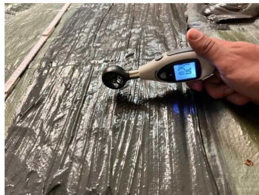
Figur 10 en bild på när luftflödet mäts med en anemometer.
