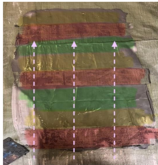
Figur 9. Illustration av tagna stickprov, där varje stickprov representeras med en egen färg. I de fall där lufttorkningsprocessen kvantifieras, visualiserar pilarna luftflödet med de tre pilarna.
