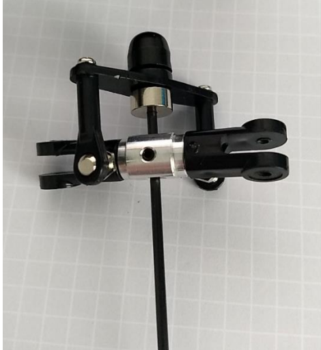
Figur 7. Exempel på en varierande stigning design i plast
