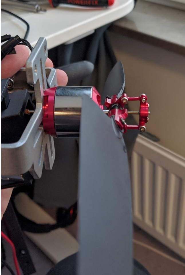
Figur 16. Propeller med justerad stigning
