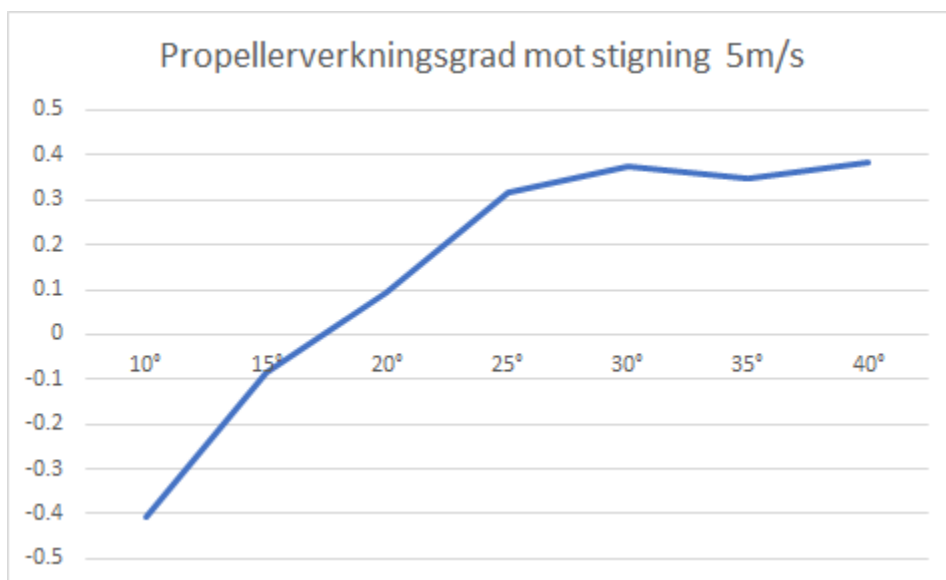
Figur 35. Propellerknivningsgrad jämfört med stigning vid 5m/s
