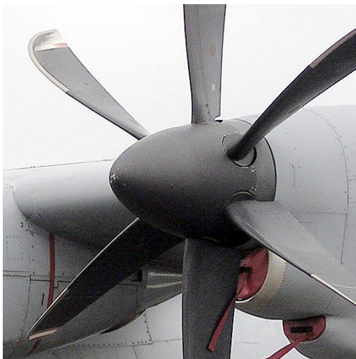
Figur 6 Ett propellernav från ett C-130J Super Hercules med varierande stigning, Taget via [4] av Pingstone.A
