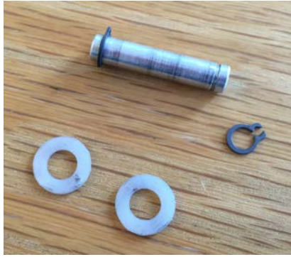
Figur 6.6. Led A:s aluminiumpinne med tillhörande nylonbrickor och låsringar
