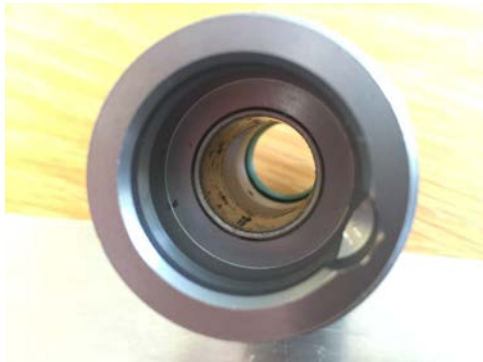
Figur 6.7. Tunnväggig bussning i cylinderns ena ände
