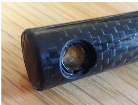
Figur 6.4. Intryckt oljebronsbusning i kolvrörets ena ände där det sitter en bit kolfiberstav. Runt oljebronsbusningens kant ses en limfog
