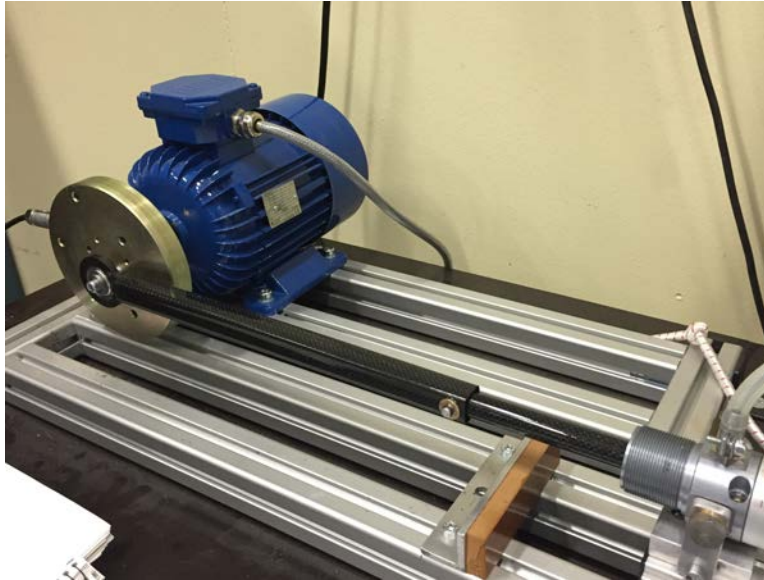
Figur 6.8. De nya delarna monterade på testriggen
