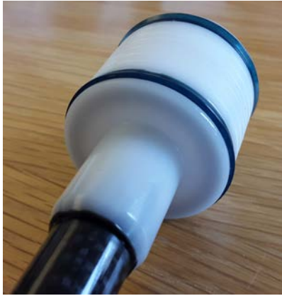
Figur 6.2. Kolv limmad på kolvstång. Det kan ses att en del av det lim som trycktes in i den utstickande delen av kolven bildar en slags limfog.
