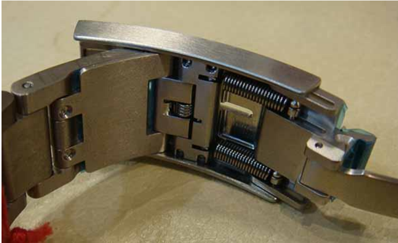
Figur 6.2, Tudor Pelagos-vinklås med fjädrande mikrojustering.
