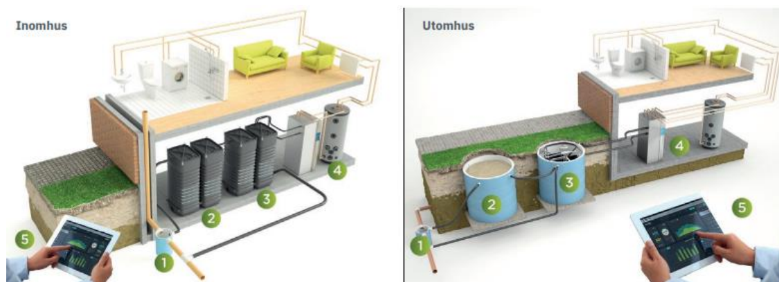
Figur 10. Evertherms värmepumpslösning, övergripande systembeskrivning
