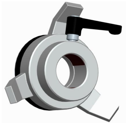
Figur 11.3, Nuvarande klove hopmonterad
