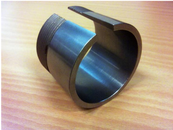
Figur 12.2, Inre konisk spännring ur spännelement
