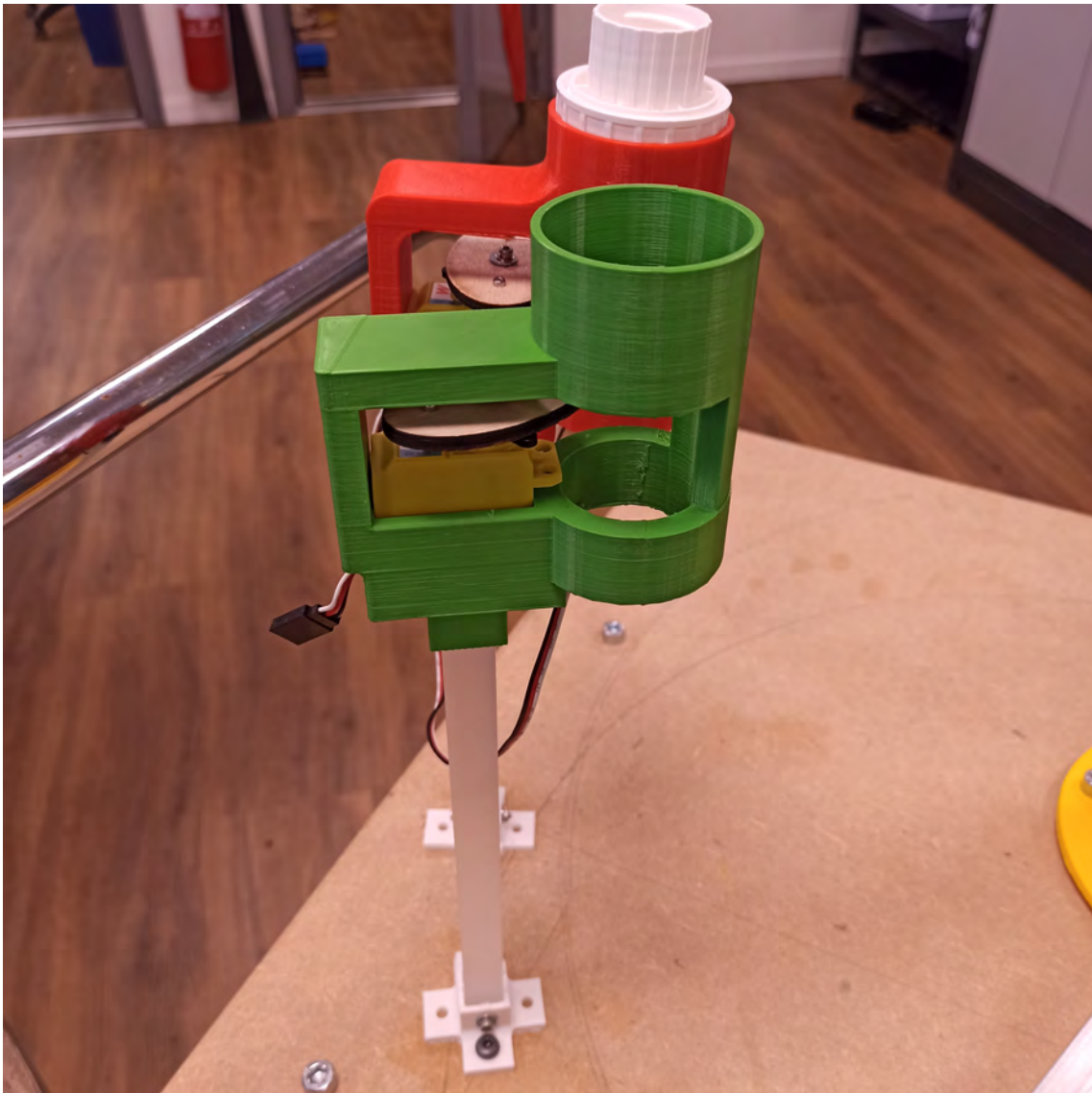
Figur C.7: De två såspumparna fastmonterade i basplattan, den bakre pumpen har spenen placerad i sig.
