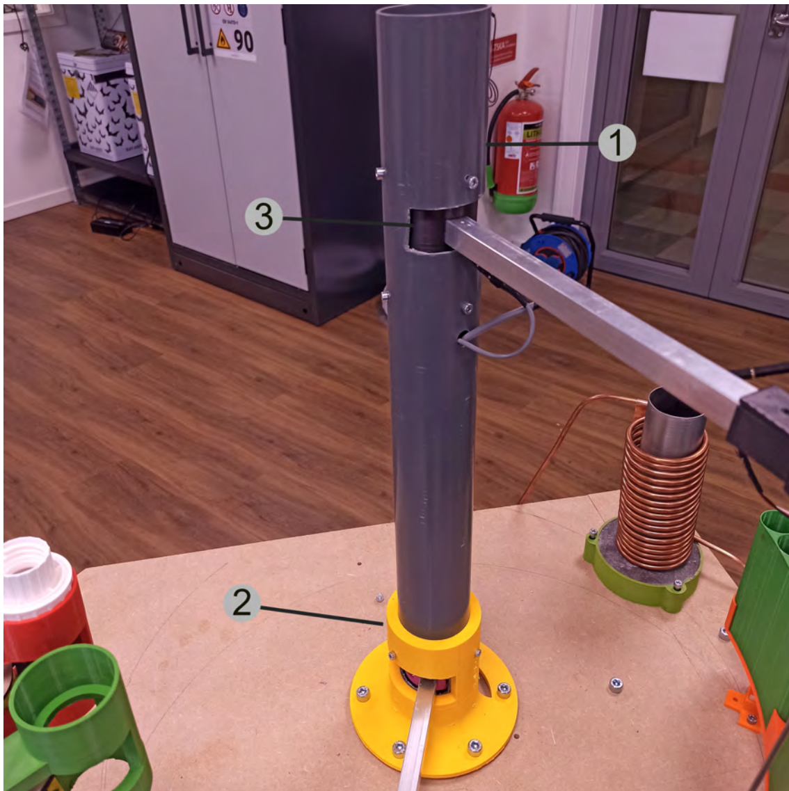
Figur C.2: Basspelaren (1) fastmonterad på vagnen med monteringsstrukturen (2) samt puckpaketen (3) monterade inuti
