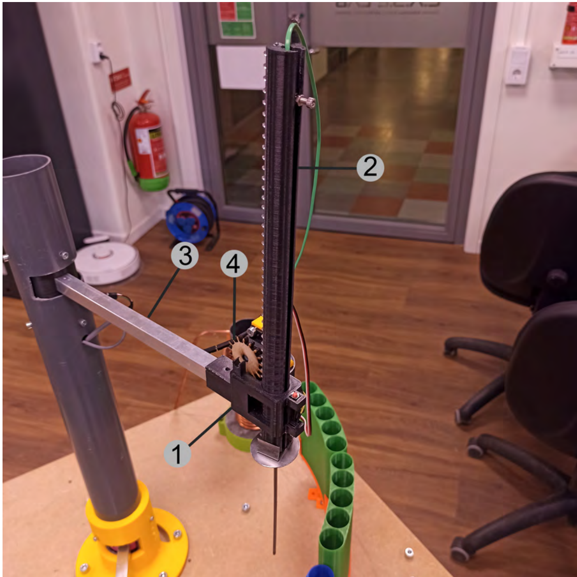
Figur C.3: Korvhissen monterad på baspelaren. Strukturen (1), med cylindern (2) imonterad, fäst på armen (3). Ytterligare är kugghjulet (4) fäst.
