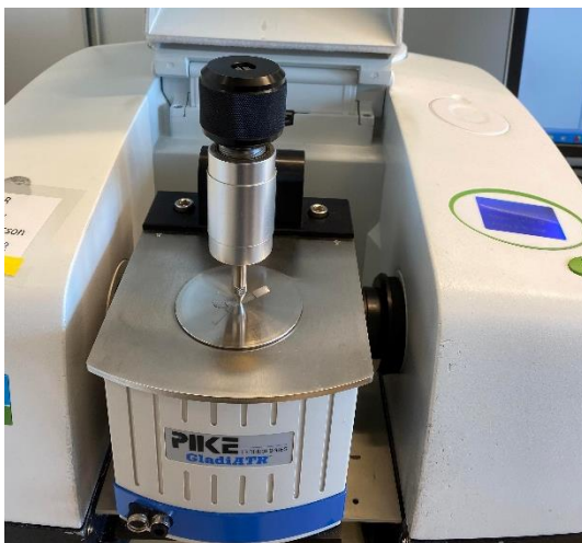
Bild 3. FTIR apparatur för kemisk identifiering karaktäriserar en CNC-film
