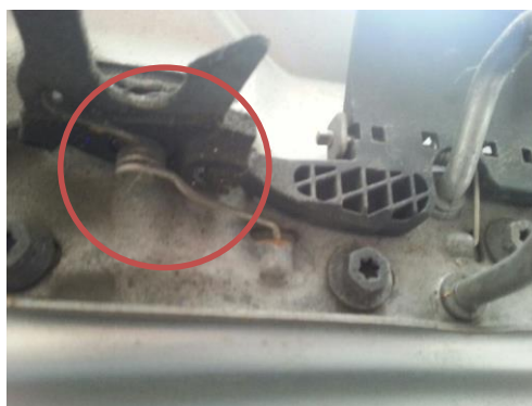
Figur 5.4, Skruvfjäder i motorhuvlås från Volkswagen Passat Combi TDI Eget foto.
