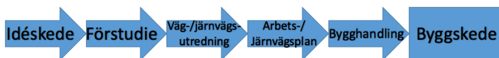
Figur 2.1 - Trafikverkets planläggningsprocess, konsulter används genom hela processen medan entreprenörer oftast kommer in mot slutet av processen (egen illustration)
