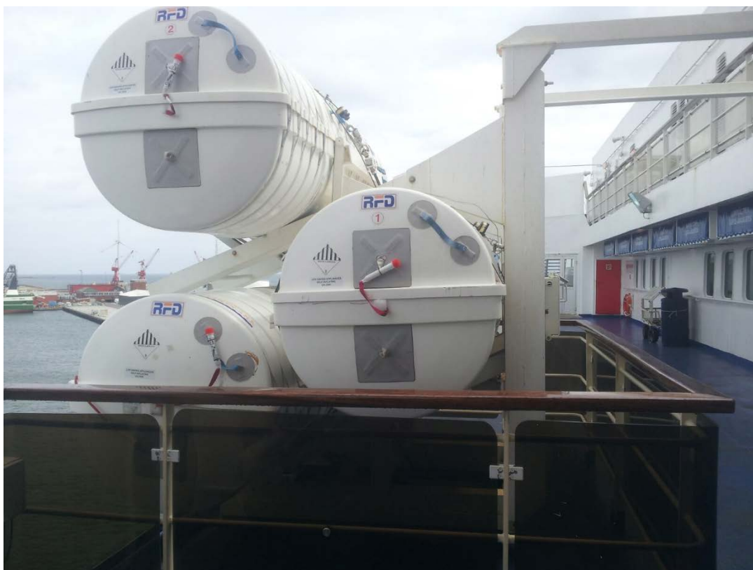
Figur 2.1 Förvaring av räddningsflottar ombord Stena Danica
