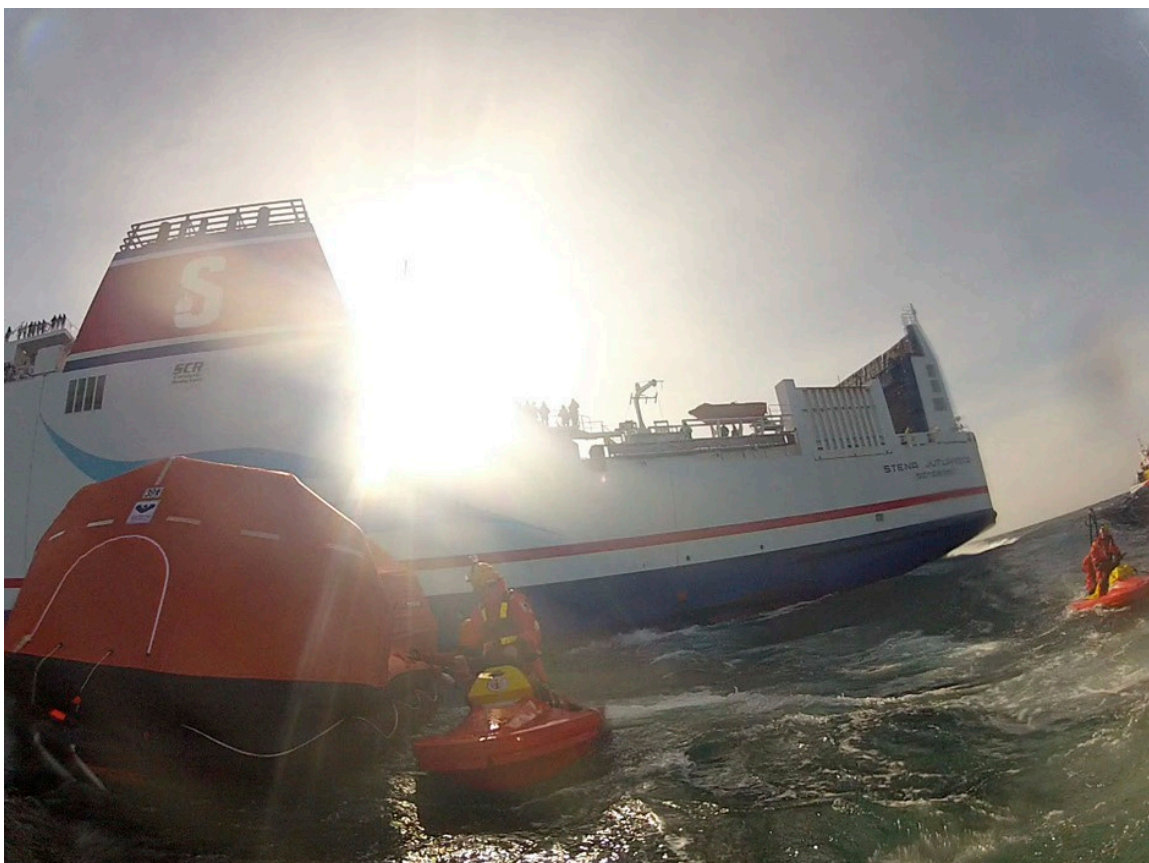
Figur 1.1. Manuell fastkoppling av vajer i flotte (First-Rescue.org, 2012). Återgiven med tillstånd
