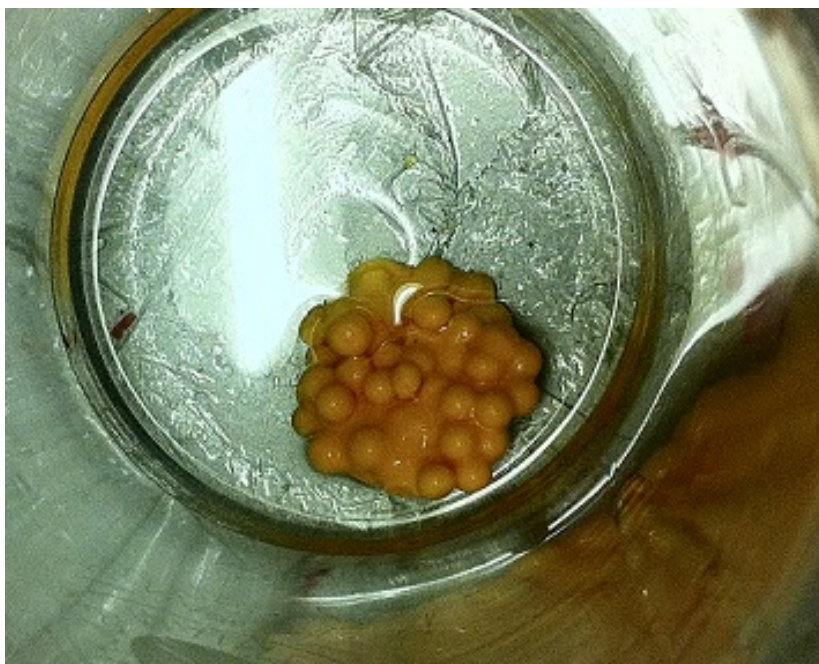
Figur 9: Vid HMTA/uran-kvot 1.0 gelerade inte mikrosfärerna tillräckligt fort, vilket ledde till att de klumpade ihop sig.
