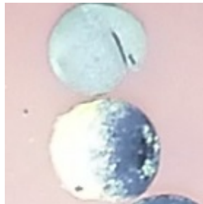
Figur 15: Den övre mikrosfären innehåller tensid, den under gör det inte. En tydlig skillnad ses.
