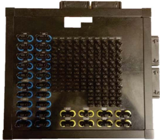
Figur 7, Brytbox, som idag används för att injicera fel
